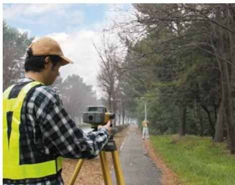
La prima tecnologia al Mondo "Oscilla e Leggi" offre un'ulteriore opzione di rilevamento che permette al canneggiatore di oscillare la stadia avanti e indietro, invece di tenere sotto controllo la verticalità della stadia.
